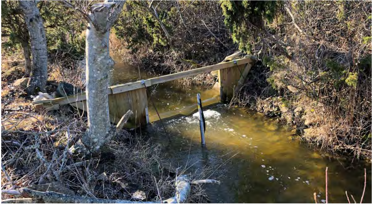
Figur 3. Station för flödesmätningar genom ett sk Thomsonöverfall i utloppsbäcken, den 1 mars 2022. Foto: Lars Vallin
