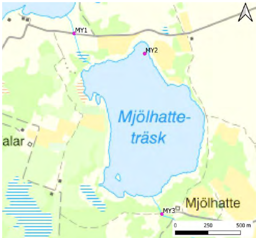
Figur 16. Mätstationer i och omkring Mjölhatteträsk. Flödesmätning i diken vid in- och utlopp av sjön MY1 och MY3. Mätstationen MY2 är installerad i själva sjön och mäter vattendjup.
