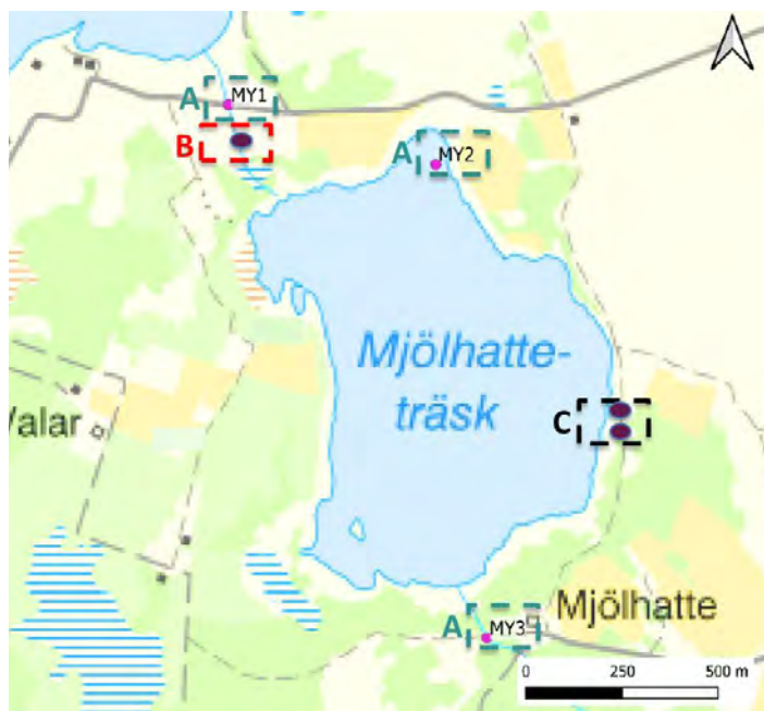
Figur 1: De installationer som berör MKB:n och som ingår i Testbädd Storsudret för hållbar vattenförsörjning. A. Mätsystem för flöden och vattennivåer, B. Automatisk dammlucka för att hålla kvar regnvatten på land samt C. Containrar för bevattningsanläggning samt pilotutrustning för vattenbehandling.
