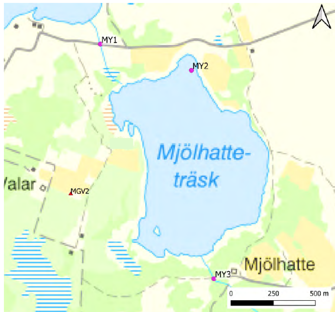
Figur 11. Mätstationer i och omkring Mjölhatteträsk. Flödesmätning i diken vid in- och utlopp av sjön MY1 och MY3. Mätstationen MY2 är installerad i själva sjön och mäter vattendjup.
