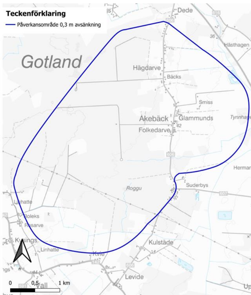
Figur 8. Uppmätt och bedömt påverkansområde vid provpumpning med 600 m 3 /dygn under en period utan grundvattenbildning.
